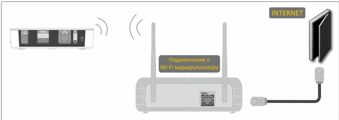
Рисунок 13 – Подключение к сети провайдера, используя Wi-Fi маршрутизатор
